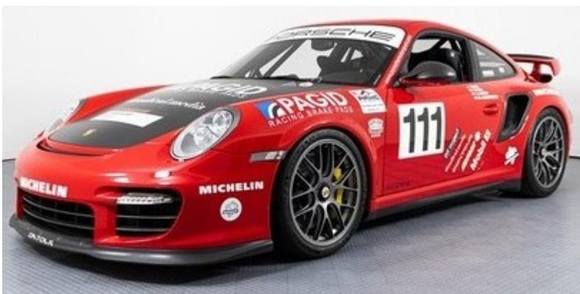
massimizzare la vocazione sportiva della GT2, si è rinunciato alla trazione integrale per optare alla classica trazione posteriore, e la trasmissione è disponibile esclusivamente in configurazione manuale a 6 rapporti ad innesti ravvicinati.
