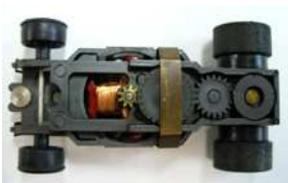
Il modello Aurora AFX Gplus con il motore piazzato verticalmente
