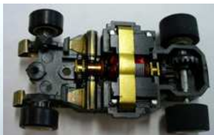
La sua evoluzione Aurora AFX Super Gplus, con il motore già nella posizione distesa.
