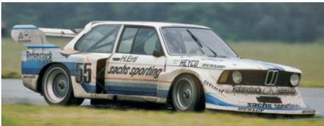
Come permesso dal regolamento la BMW 320 viene ampiamente modificata con grandi passaruota che permettono l'uso di pneumatici molto larghi, varie appendici aerodinamica cambiano completamente l'aspetto dell'auto.
