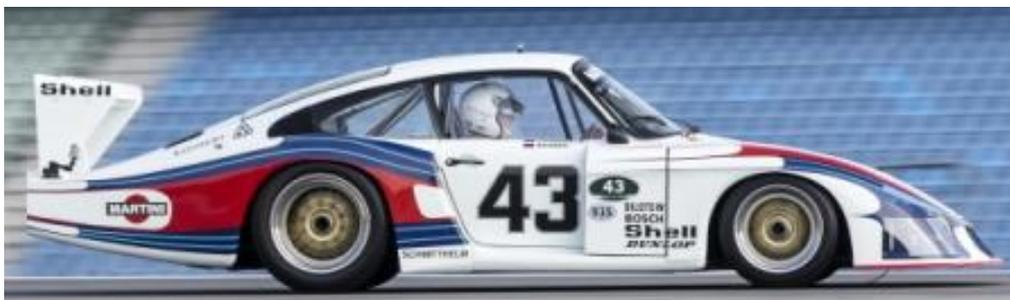
e, come tocco finale, si abbassò l'intera vettura di 7,5 cm sfruttando un buco regolamentare; la linea aerodinamica venne aggiornata con una sinuosa coda aerodinamica e un lungo e affusolato muso, studiati per le alte velocità raggiunte a Le Mans. Per le dimensioni giunoniche ed il colore ufficiale bianco usato nei primi collaudi, il modello 935/78 venne soprannominato "Moby Dick".
