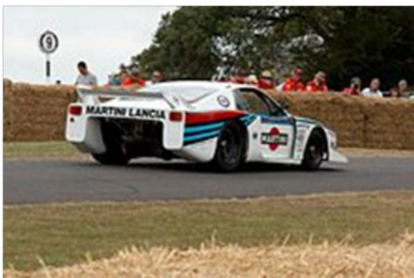
In alcune gare del 1980 viene utilizzato un motore con cilindrata leggermente maggiorata di 1,4294 litri (pari a 2001 CC) per rientrare nella categoria superiore ai 2000 cm<sup>3</sup> ed erodere punti alle Porsche, mentre nel 1981, si prova un 1773 cm<sup>3</sup> che incrementa la potenza di 10 CV. Il motore viene abbinato a un cambio manuale a cinque rapporti e retromarcia con differenziale autobloccante e frizione bidisco a secco.
