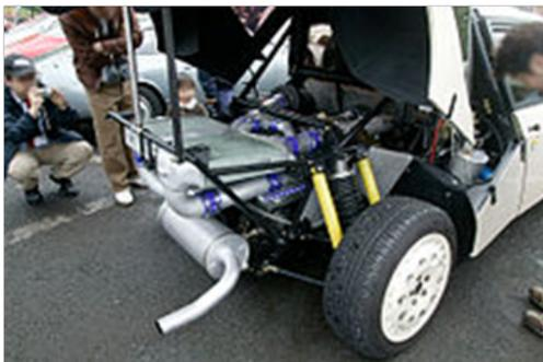
Vi era un sistema di doppia sovralimentazione: un turbocompressore KKK k27 con in più un compressore volumetrico Volumex, brevettato dalla Abarth.
