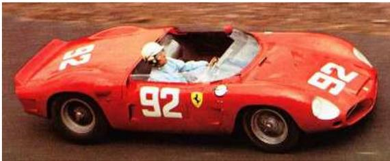
Questo modello fu il primo costruito dalla Ferrari ad aver montato il motore centralmente. Questo motore aveva una peculiarità: era un V6 che possedeva l'angolo tra le due bancate di 65°.
