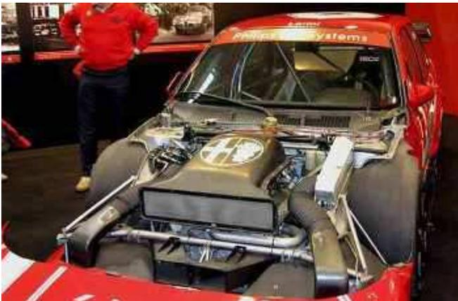
Presentata nel 1993, la 155 V6 TI, esteticamente riproduceva quasi la stessa linea esteriore della Alfa Romeo 155 stradale, anche se in realtà era un vero e proprio prototipo nel quale meccanica e carrozzeria erano profondamente rivisti per l'utilizzo nelle competizioni. Il telaio era di tipo tubolare, costituito da una complessa struttura a traliccio di tubi di acciaio, dentro al quale in posizione anteriore era adagiato il motore.
