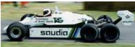
Tutte queste soluzioni partivano per risolvere un problema, quello di scaricare la potenza a terra. Ma furono tutte abbandonate. Solo Tyrrell, con il progettista della P34, Derek Gardner, usò 4 piccole ruote all'anteriore, soprattutto per motivi aerodinamici. Riducendo la sezione frontale della sua F1, riuscì ad avere così una macchina velocissima.
