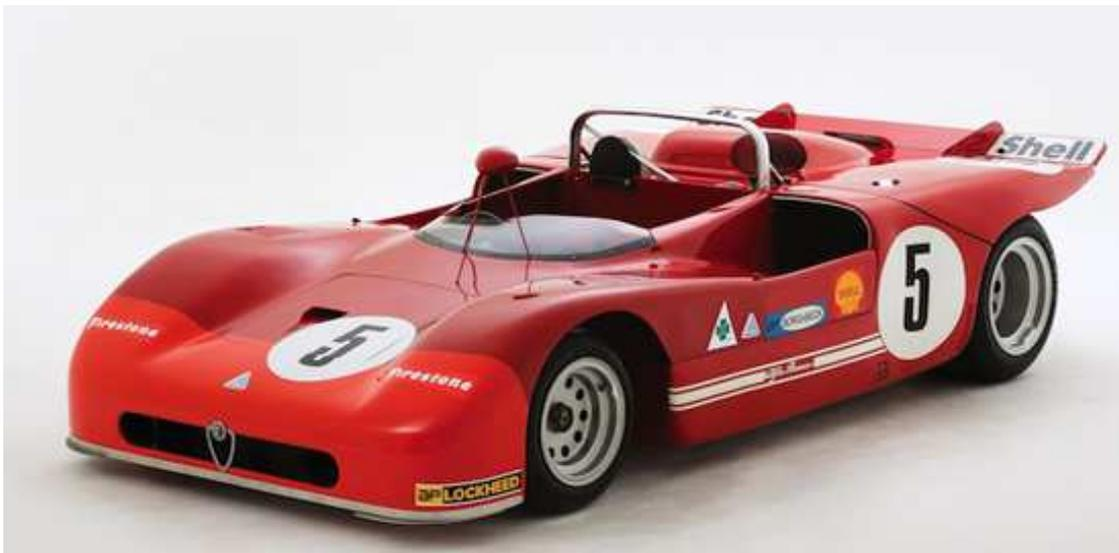
Il debutto della **Alfa Romeo 33 /3** fu nel 1969 alle 12 Ore di Sebring; montava un motore 8 cilindri V90° di 2.995 cm<sup>3</sup>, che erogava una potenza di circa 425 CV per un peso di poco inferiore ai 700 kg.
