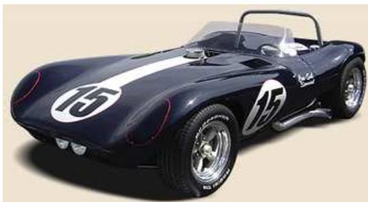
**e secondo** ancora più grave, e questo era un grosso limite di progetto. A causa della forte pressione dell'aria che si formava all'interno dell'abitacolo, con l'aumento della velocità, praticamente esplodevano le porte e il lunotto posteriore. Questo successe un paio di volte, durante le prove in circuito e il pilota si trovava veramente spaesato più o meno a 300 km orari!
